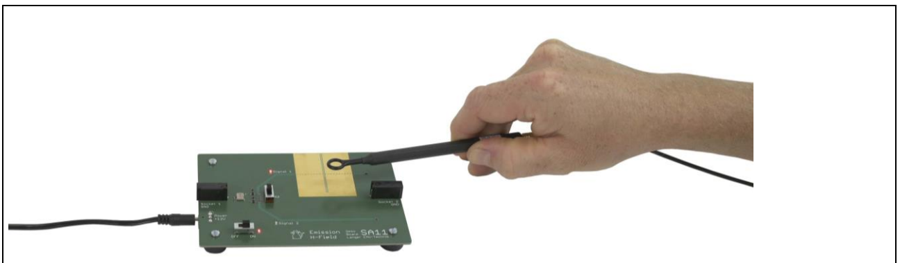
Bild 29: Magnetfeldmessung am SA 21 mit der Nahfeldsonde RF-R 50-1
