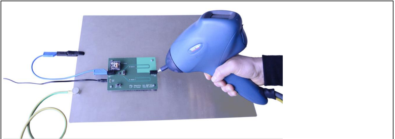
Bild 23: Versuche mit ESD-Generator über einer Metallfläche
